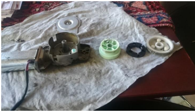
Motor und Getriebegehäuse vom Barchetta, - Kunststoffteile vom Kappa KC Original 2,4 ltr. Bj. 2000
