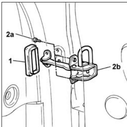
1. Den Schutzgummi abhebeln und entfernen.
