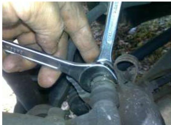
una volta mollati i due bulloncini, la pinza è libera (quasi) di ruotare per accedere al cilindro maestro. Adesso viene la parte "difficile". Bisogna avere un morsetto con la parte che si muove, che possa ruotare liberamente. Il mio andava perfettamente a coprire il pistone.
